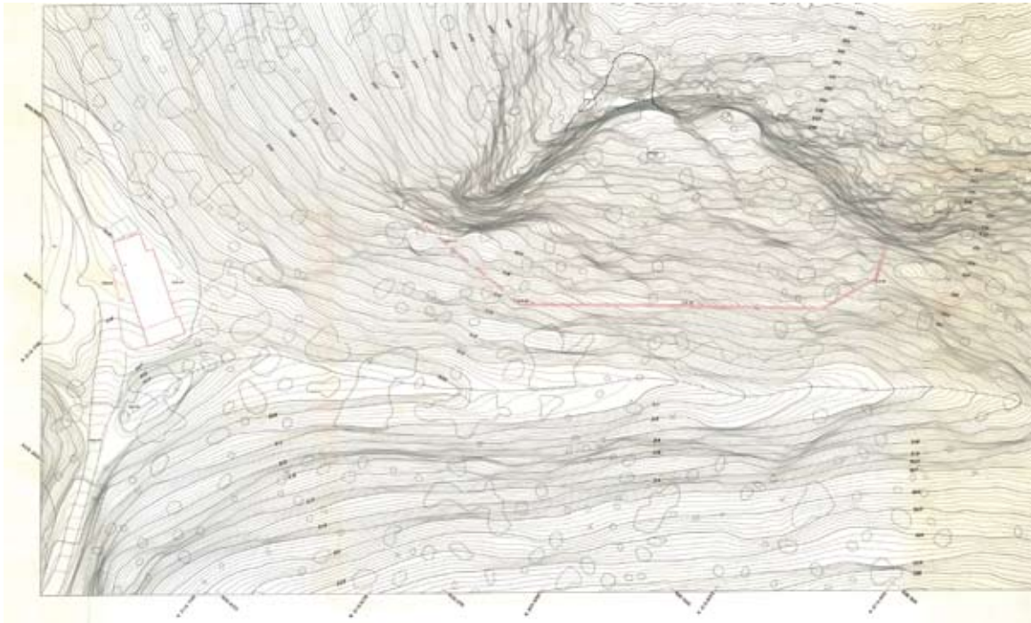
La fotogrametría aérea resulta muy adecuada frente a la clásica por su mayor precisión, rapidez y menor coste económico. Abrigo de El Milano, Mula, Murcia.
