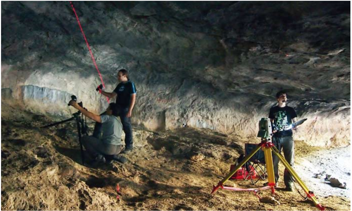
Fig. 4. Proceso de documentación geométrica de la cueva de la Fuente del Trucho, Parque Cultural del Río Vero (Huesca). Registro realizado a través de la combinación de técnicas de topografía, fotogrametría, láser escáner de diferencia de fase y escáner de luz blanca estructurada. Documentación realizada dentro del proyecto: "Ventanas digitales al arte rupestre en el noreste ibérico". Proyecto financiado por el Ministerio de Educación, Cultura y Deporte (Imagen cedida por Tecnitop S.A.).
